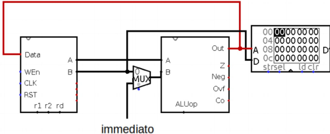
→ **3)** *Scrittura all'interno del Regfile del risultato di un'operazione ALU.*
